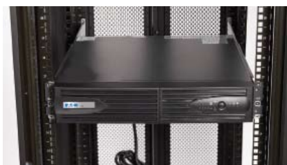
Instalación en rack de 2 U
